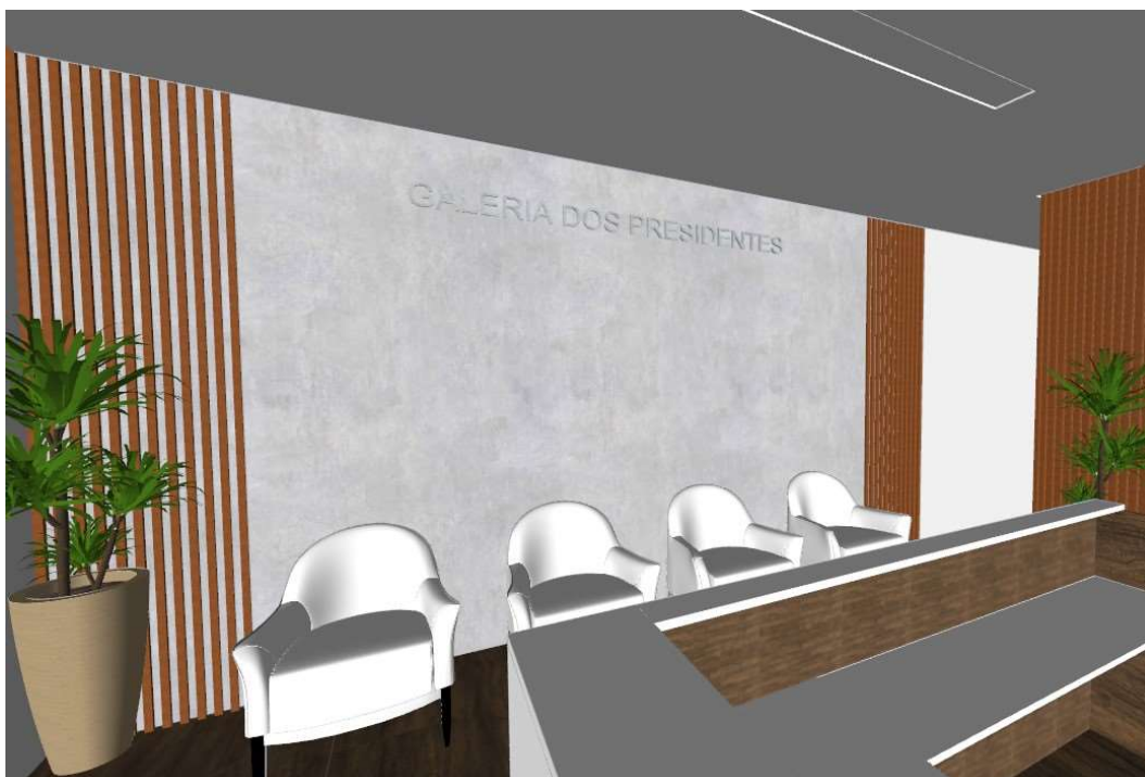
Figura 19: Parede da Recepção com efeito de cimento queimado
