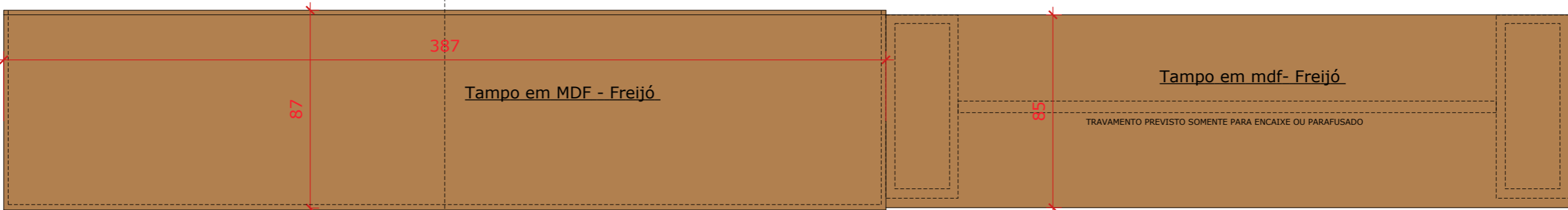
PLANTA BAIXA - BANCADA DE ENCADERNAÇÃO/IMPRESSÃO Escala: 1/20
