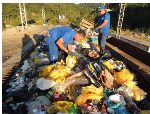
Figura 74 – Rompimento dos sacos para dispersão dos materiais
