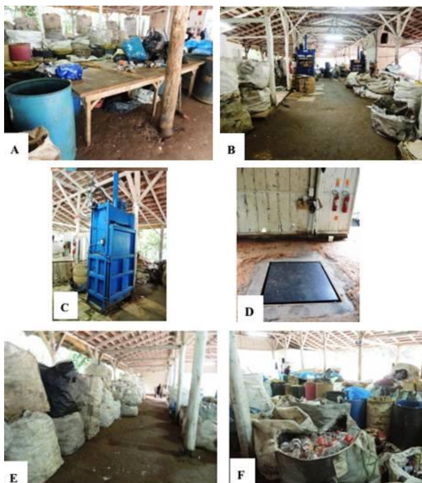
Figura 12 – Galpão regularizado em Jaraguá do Sul que recebe parte da carga da coleta seletiva formal: mesa de triagem (A), prensas (B e C), balança digital e extintores de incêndio (D), bags (E) e tambores (F) para armazenar os materiais e rejeitos
