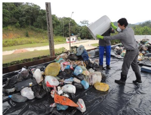
Figura 72 – Disposição dos resíduos da bombona sobre uma lona
