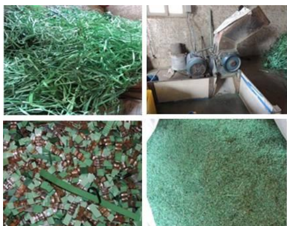
Figura 63 – Recicladora informal em Barra Velha: beneficiamento de lacres de plástico
