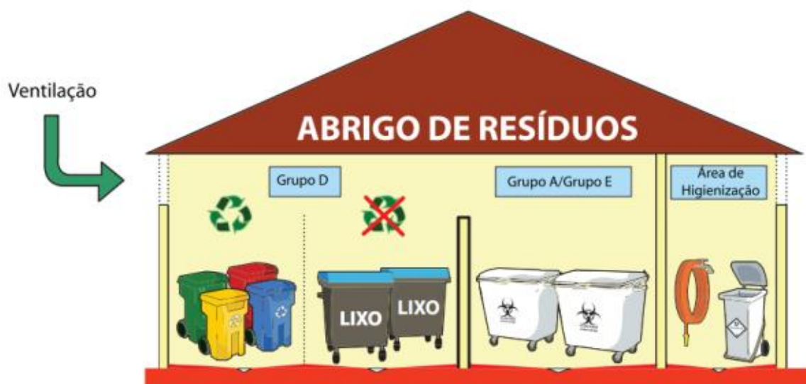
Figura 113 – Exemplo de abrigo de resíduos para os Grupos A, D e E
